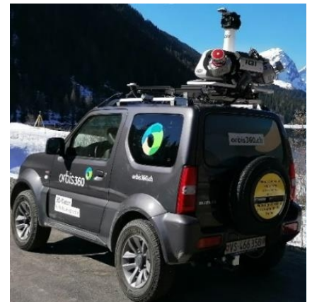
Figure : Système de mesure mobile installé sur véhicule
